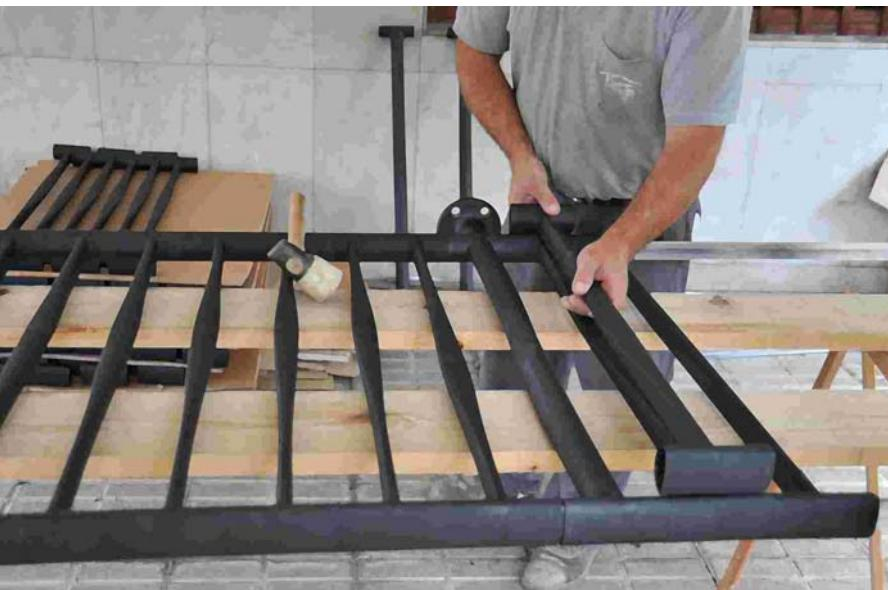
Sobre un caballete o mesa de montaje debidamente protegida para evitar maltratar los barrotes, apoyar los tramos de tubo pasantes e ir introduciendo por ellos las columnas y barrotes, (observando el diseño de los mismos para hacerlo en la misma posición, pudiéndose alternar o combinar a elección. Teniendo en cuenta que coincidan el macho y hembra de los elementos).
