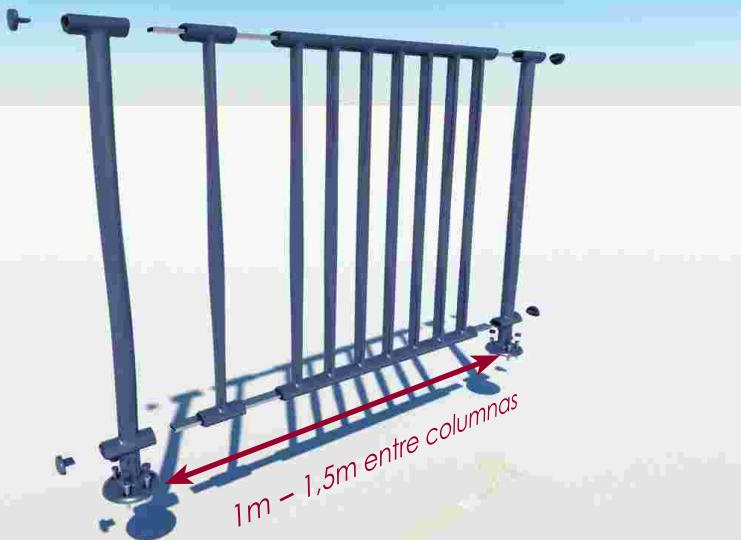
Cortaremos los tubos pasantes de acero galvanizado superior e inferior a la medida necesaria, considerando los remates a utilizar en los finales de las barandilla, si son codos, tapas o fijaciones a pared.
