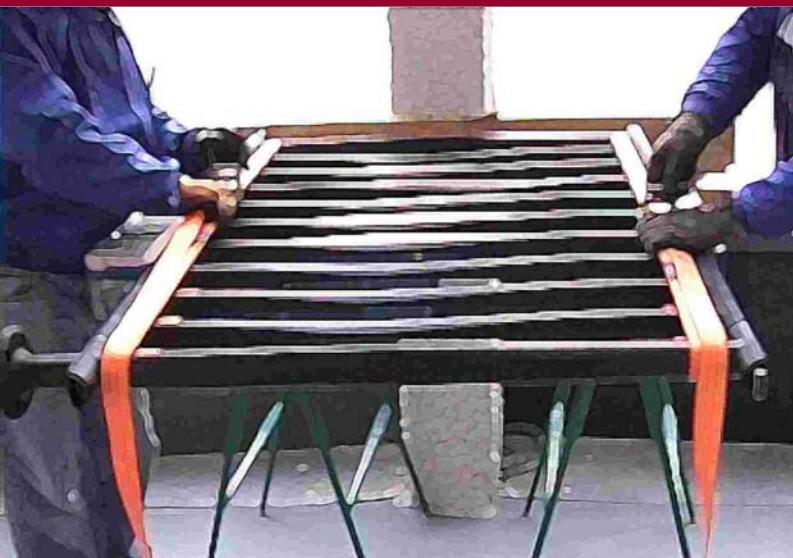
Formado el conjunto de columnas y barrotes, colocaremos unas cinchas para conseguir una unión sin holguras. Apretándolas nos aseguraremos de un buen acoplamiento de las piezas, pudiendo utilizar un mazo de nylon o goma para ayudarnos en caso necesario.
